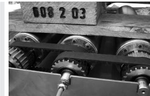
Bei Anwendungen ohne Förderband oder mit einem schmalen Band, das weniger als 70 % der Trommelmotorbreite bedeckt, kann die Wärme des Motors nicht mehr über das Band abgeleitet werden. Für solche Anwendungen empfehlen wir einen 2-poligen Asynchron-Trommelmotor oder Synchron-Trommelmotor mit einem Frequenzumrichter einzusetzen.
