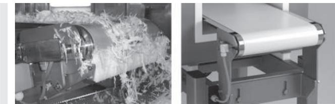
Reibungsangetriebene Bänder werden über die Reibung zwischen Trommelmotor und Förderband angetrieben. Der Trommelmotor ist in der Regel ballig ausgeführt, um ein Verlaufen des Bands zu verhindern. Das Band muss gespannt werden, damit das Drehmoment des Trommelmotors übertragen werden kann. Die Bandoberfläche kann flach, glatt oder mit Stegen, Nuten oder Rauten versehen sein.
