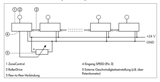
Um die Geschwindigkeit des Förderers von extern zu steuern, kann ein externes Signal SPEED angeschlossen werden. Das Signal darf nur an einer ZoneControl angeschlossen werden, da es über die PTP-Verbindung an alle anderen ZoneControl weitergegeben wird. Dabei ist die Position der ZoneControl innerhalb des Förderers und die Leitungslänge der PTP-Verbindung egal.
