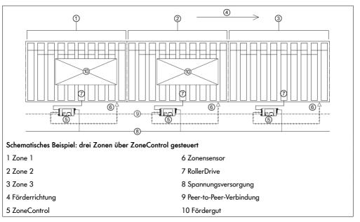
Der Sensor der Zone 1 hat ein Fördergut erkannt. Die ZoneControl von Zone 1 schickt eine Anfrage an Zone 2, ob das Fördergut weiter befördert werden kann. Da sich in Zone 2 ebenfalls ein Fördergut befindet, verneint die ZoneControl von Zone 2 die Anfrage, bis das dort befindliche Fördergut zu Zone 3 weiterbefördert wurde (Modus Einzelplatzabzug) oder zumindest der Weitertransport begonnen wurde (Modus Blockabzug).
