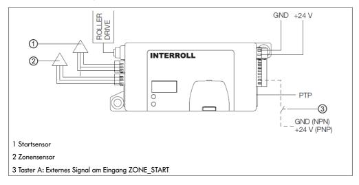
Handshake zu vorhergehender Förderstrecke: Der Zonenstatus (belegt oder frei) kann über das Signal ZONE\_ STATUS abgefragt werden (siehe "ZONE\_STATUS", Seite 22). Das Starten der ersten Zone des ZoneControl-Förderers kann mit folgenden Möglichkeiten realisiert werden:
