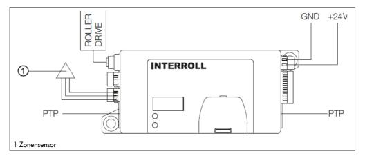
Diese ZoneControl kann sich an einer beliebigen Stelle zwischen Start- und Endzone befinden. Diese Beschaltung ermöglicht staudruckloses Fördern ohne Zusatzfunktionen.
