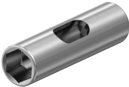
L'adattatore di fissaggio serve a stringere il dado di fissaggio del RollerDrive alla corretta coppia di serraggio con una chiave dinamometrica. L'adattatore è provvisto di un'apertura laterale per far passare il cavo di collegamento del RollerDrive.
