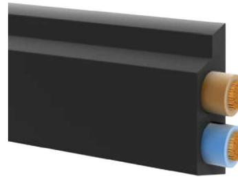
Le câble plat sert à l'alimentation en tension des cartes ConveyorControl et MultiControl. Le contour extérieur du câble est conforme à la norme AS interface. L'enveloppe du câble obture les orifices résultant des contacts de vampirisation. La classe de protection du câble est ainsi préservée même après le débranchement ou le déplacement d'une carte de pilotage.
