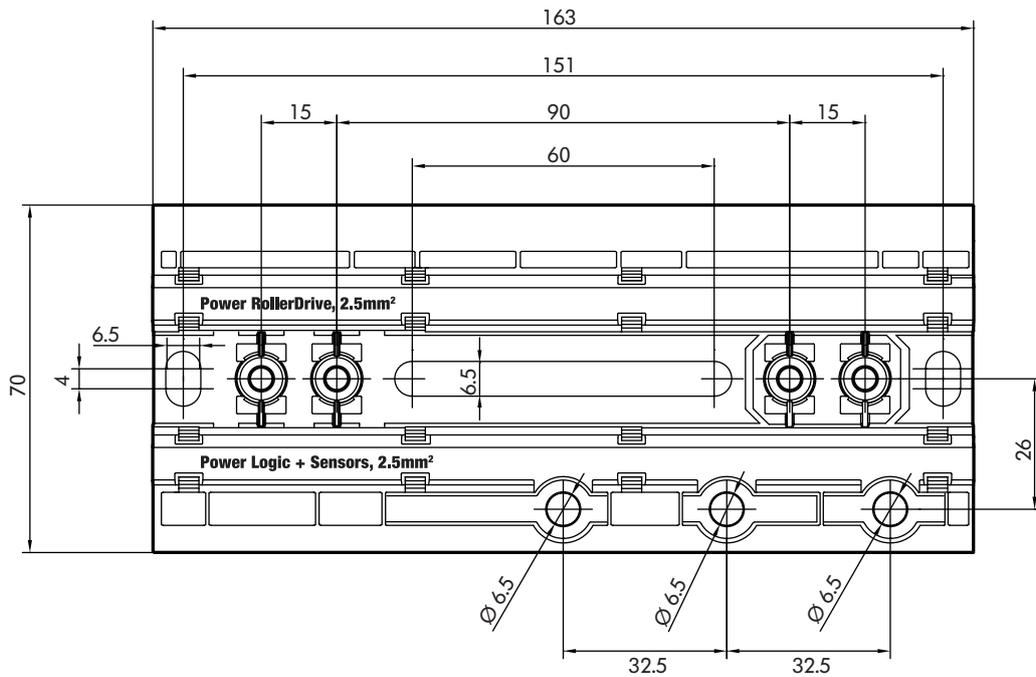
Um den Magnetschlüssel platzieren zu können, muss der Abstand von der Oberkante der MultiControl zu benachbarten Bauteilen mindestens 10 mm betragen.
