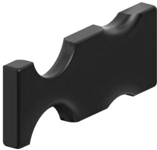
El medio auxiliar de tensado PolyVee permite tensar de manera fácil correas PolyVee de 2 y 3 nervios y se ha previsto para los pasos entre rodillos 75 mm y 100 mm. El medio auxiliar de tensado se ha concebido para rodillos y RollerDrive con un diámetro de 50 mm. En tubos con revestimiento tubular o elementos cónicos no se puede utilizar.
