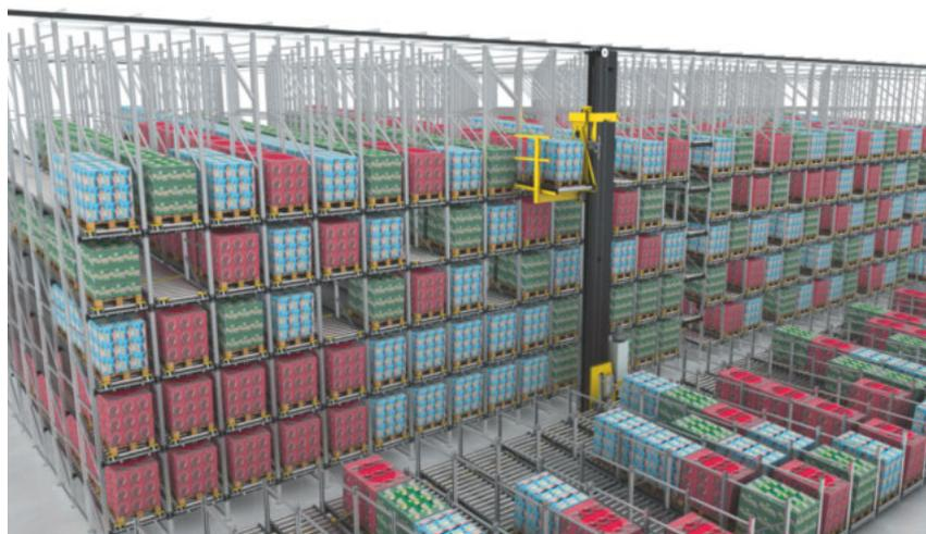
Interroll Regalbediengerät und Verfahrwagen als Erweiterung der Modular Pallet Conveyor Platform (MPP) ermöglichen die durchgängige Verknüpfung von automatisierter Förderung mit automatisierten Lagerprozessen.
